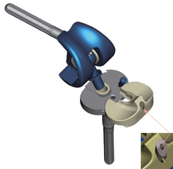
Obr. 65 – sestava implantátu Obr. 66 – detail zavedení zátky
