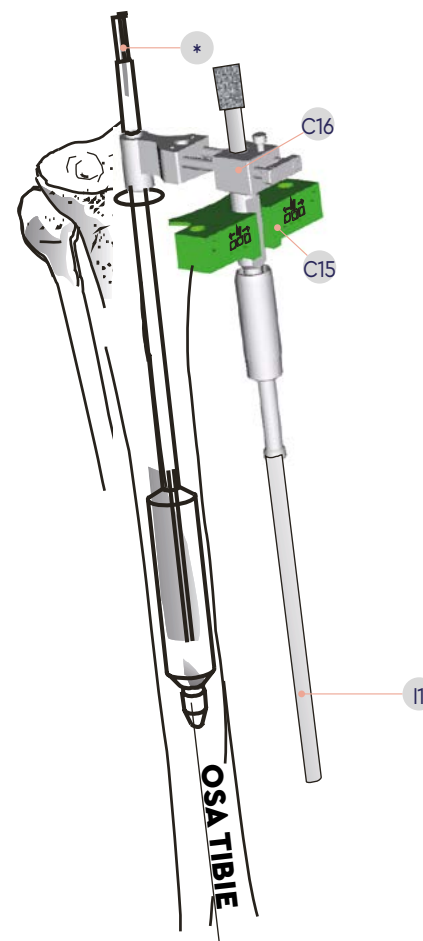
Obr. 8 – sestava intramedulárního cíliče a vodící tyče doplněná centrovací tyčí
