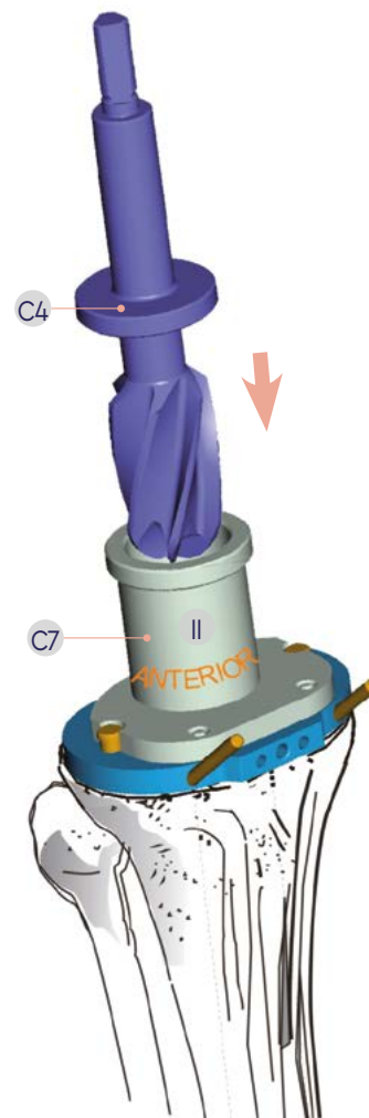
Obr. 17 – úprava kanálu pro výstupek tibiálního plata
