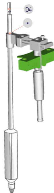
Obr. 7 – úplná sestava IM cíliče a vodící tyče
