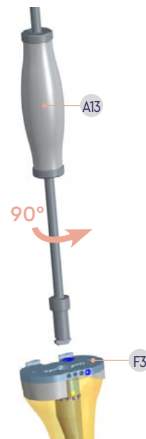
Obr. 26 – sestava kluzného kladiva A13 a zkušební tibiální komponenty F3
