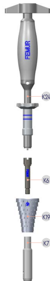
Obr. 73 – sestava pro zavádění rašple
