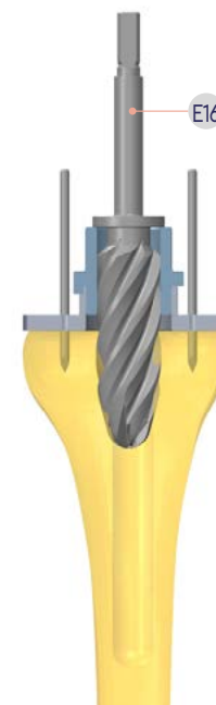
Obr. 17 – frézování lůžka – poloha frézy po jeho dokončení
