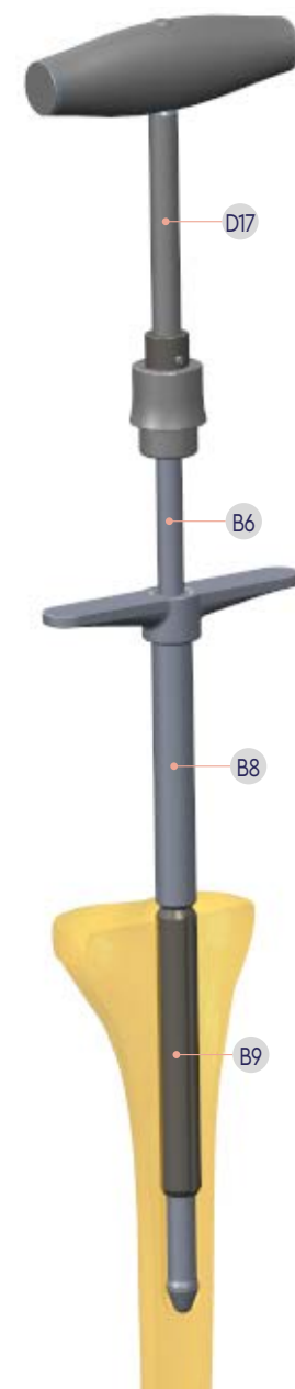
Obr. 5 – sestava vodící tyče, pouzdra, přítlačného pouzdra a držadla „T“
