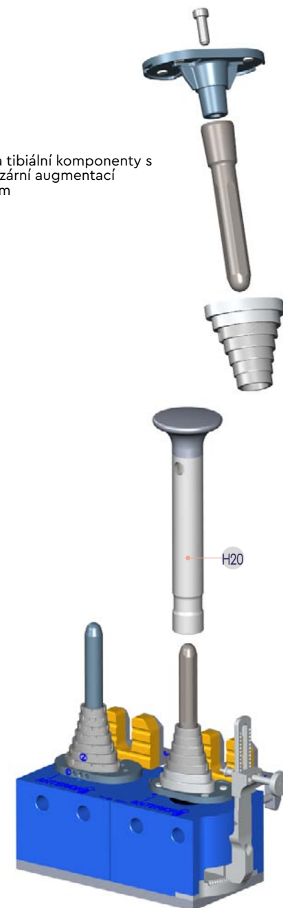
Obr. 87 - montážní přípravek v sestavě s tibiální komponentou (zkušební a implantát) a doražečem metafyzární augmentace
