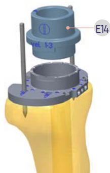
Obr. 16 – příprava sestavy k frézování lůžka pro offset
